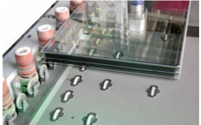
A H.B. Fuller | KÖMMERLING speciális meleg perem rendszerének köszönhetően a hőszigetelőüveg egységek vastagsága 0,1 mm-es pontossággal állítható elő.
